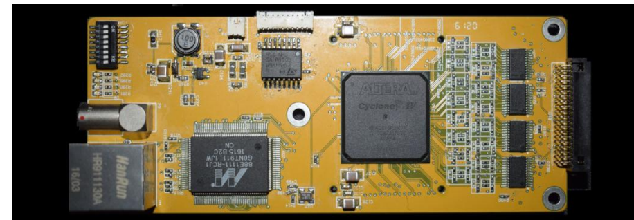
第二代单片4×36通道FPGA MVT (上: ADC板; 下: TDC板)
